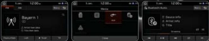
نظام صوت بشاشة ملونة مقاس 7 بوصات تعمل باللمس تشتغل شاشة LCD الـ7 بوصات في عرض الصورة من كاميرا العرض التقليدية ونظام الصوت مما تمكنك الشاشة الأخيرة من اختيار معدلات الراديو بسهولة وتشغيل لوحة التحكم بنظام الصوت من خلال لمسها باللمس فقط.
